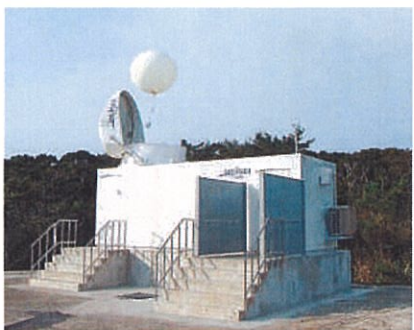
自動放球装置から飛び出すラジオゾンデ (気象庁ホームページより)
